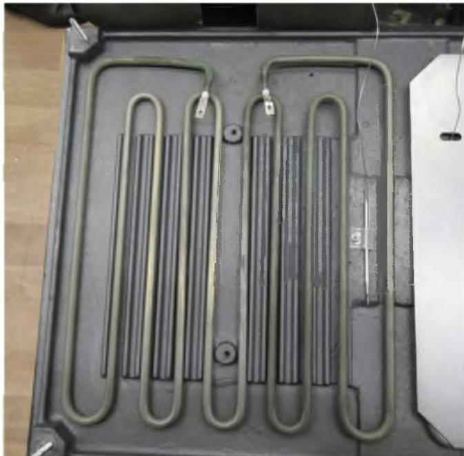
Правильное расположение нагревательных элементов и толстые чугунные рабочие поверхности (10 мм) предотвращают образование «неактивных» зон – поверхность греется равномерно по всей площади.
