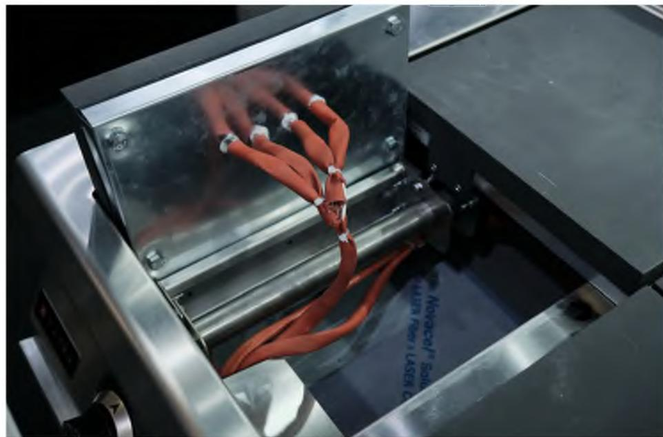
Продуманная компоновка тэнов даёт возможность при низком электропотреблении готовить большие объёмы продукции, в частности, варка в больших котлах.
