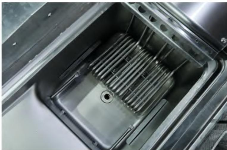
Датчики измерения температуры находятся в колбе, их невозможно повредить при мойке.
