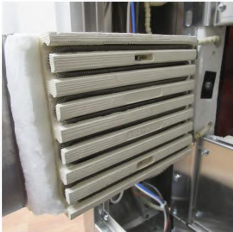
Высококачественная компоновка спиралей, в керамическом элементе, полная изоляция нагревательных элементов способствует направленной подаче тепла и минимальному износу. Специальные стеклокерамические стёкла высокой прочности. Термоизолированные провода, европейские комплектующие
