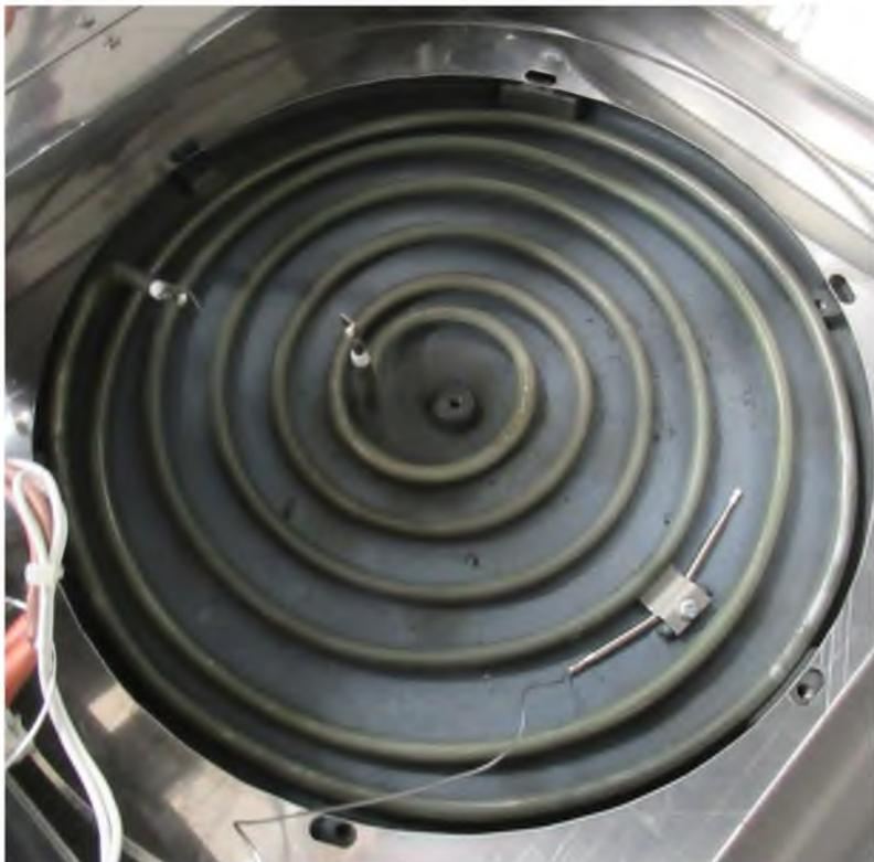
Круглый тэн полностью покрывает рабочую поверхность, что позволяет максимально равномерно распределять тепло
