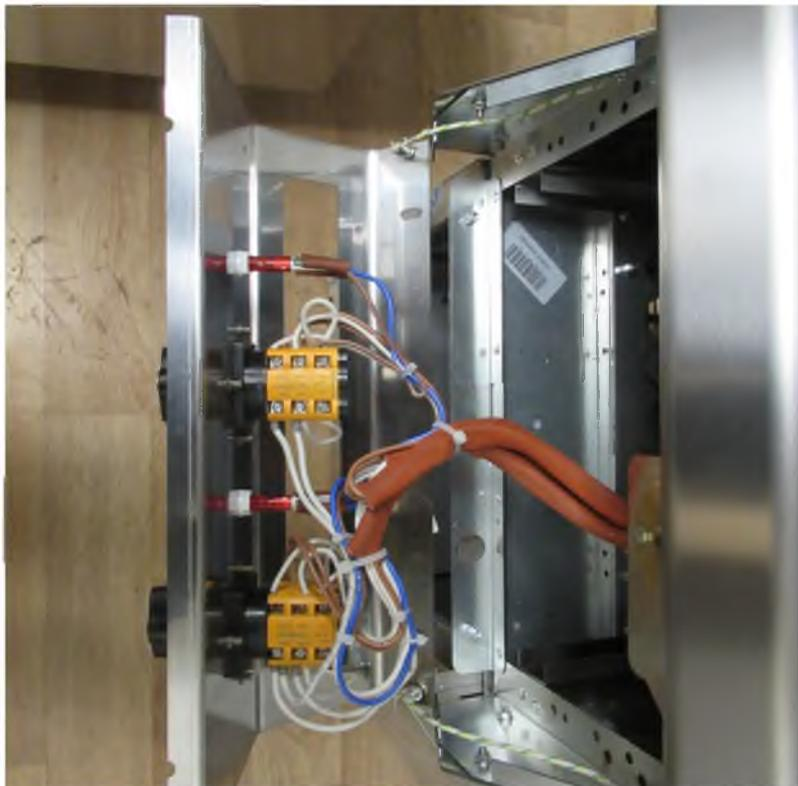
Закрытые корпусные пакетные переключатели предотвращают перегрев контактных групп. Термостойкие провода и дополнительная стекловолоконная изоляция.
